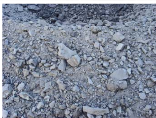
Fot. 5. | Efekt rozdrobnienia gruntu skalistego – urobek wydobyty z pala
