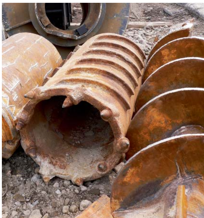
Fot. 2. | Narzędzie wiertnicze – świder koronkowy
