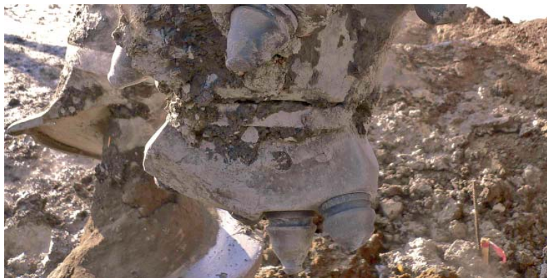
Fot. 14. | Widoczne zużycie specjalnych zębów do wiercenia w skałę przy kontakcie ze skałą twardą o wytrzymałości ok. 190MPa ↓
