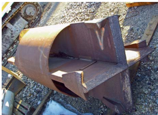
Fot. 6. | Dłuto do pala o średnicy 1180 mm
