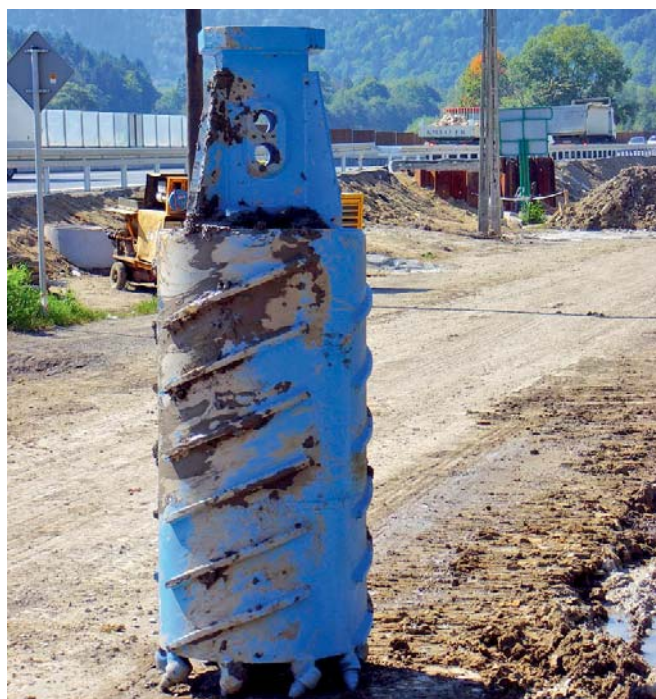
Fot. 2. | Narzędzie wiertnicze – świder koronkowy
